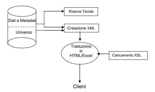
La traduzione XML + XSL = HTML viene fatta sul server, quindi il client riceve soltanto uno stream in formato HTML. Tale operazione sarebbe stato possibile farla realizzare direttamente al client, ma non tutti i client sono abilitati a farlo.
