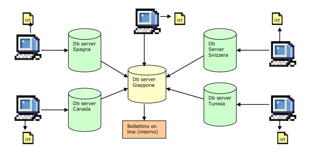
Sulla prima struttura accede un'applicazione Web interna analoga a quella esterna (che invece accede alla seconda struttura) e che viene utilizzata dai Servizi per controllare i dati prima di inviare i file di dati all'esterno.
