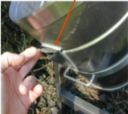
**Pluviometro totalizzatore** è un secchio che deve essere vuotato tutte le mattine alle ore 9 dal rilevatore. Con cilindro graduato si misurano i mm caduti nella 24 ore
