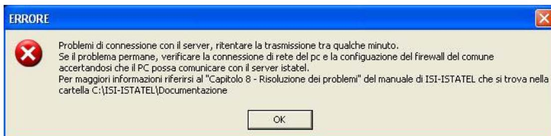
allora il PC da cui state effettuando l'invio non riesce a comunicare con il server ISTATEL. La causa più probabile di questo errore è dovuta ad una errata configurazione della rete comunale, in particolare ISI-ISTATEL comunica con il server centrale attraverso la porta 7690 che generalmente non è abilitata. Per abilitarla rivolgersi al responsabile dei sistemi informativi del comune.
